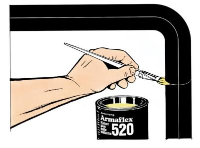
Контактный клей 520 растворяет поверхность теплоизоляции Armaflex вследствие химической реакции (эффект "холодной сварки").
